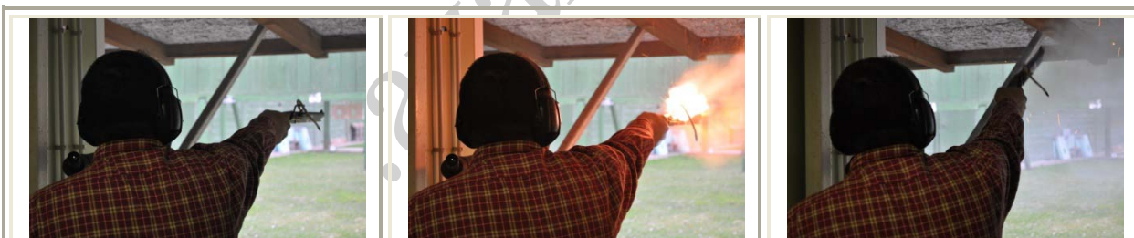
Secuencia del disparo de una pistola Tanzutsu en la que se aprecia la gran cantidad de fuego que sale y que la mecha está correctamente asegurada al “serpentin”, pues queda sujeta tras el disparo.
