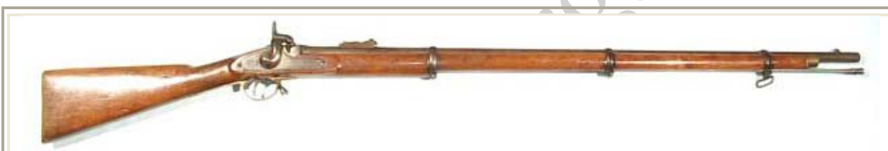
Arriba un fusil militar de percusión y ánima rayada para las disciplinas de Minié y Lamarmora. Al igual que el modelo de chispa para Miquelet, también existen diferentes variantes pero similares entre ellas. Solo pueden emplear proyectil expansivo de base hueca del tipo denominado "minié".
